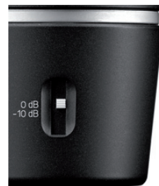
Figura 1: Comutador de seleção para a pré-atenuação
