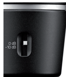
Figura 1: Conmutador-selector para preatenuación
