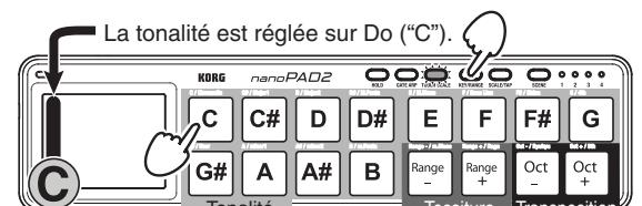
Maintenez le bouton KEY/RANGE enfoncé et appuyez sur le pad de déclenchement permettant de régler le paramètre "Key", "Note Range" ou "Octave Shift".
