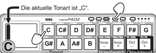
Halten Sie den KEY/RANGE-Taster gedrückt, während Sie das Pad betätigen, das der gewünschten „Key“, „Note Range“- oder „Octave Shift“-Einstellung zugeordnet ist.
