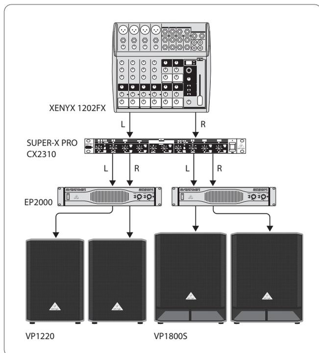
Fig. 5.3: Funcionamiento stereo de dos vías con subwoofers
