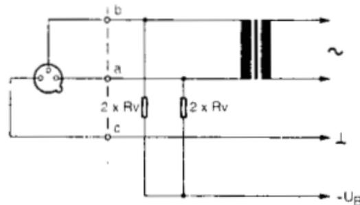
3. Si las entradas de los amplificadores tienen tierra, o si no existe un transformador de entrada, deben añadirse a las líneas de baja frecuencia ya sea condensadores o transformadores adicionales para impedir una obstaculización de la etapa de entrada por corrientes de pérdida.
