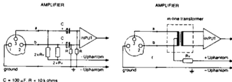
Ce montage qui peut être réalisé ultérieurement, de façon très simple et à peu de frais, sur presque tous les montages existants évite l'acquisitions d'une alimentation externe.
