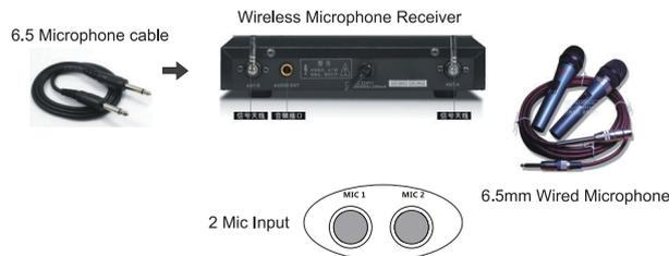
1. Esta unidad puede conectar micrófonos con cable e inalámbricos al mismo tiempo. Dependiendo de la preferencia del usuario, el micrófono con cable e inalámbrico puede simplemente conectar el cable de audio 6.5 en la interfaz de micrófono único del amplificador.
