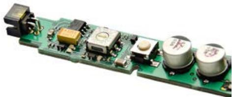
Con el módulo PAESP M es posible ajustar numerosos parámetros, como corte de graves, modo de funcionamiento del anillo LED ring (on, off, follow mic...) así como el modo de activación del micrófono (push to mute, push to talk, push on - push off).
