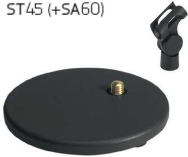
El ST45 es un soporte de mesa de referencia para una fácil instalación y uso de sistemas de microfonía móviles. Está fabricado en una sola pieza de metal, muy sólida, que lo hace muy estable. Su gran base y pie de goma anti vibraciones eliminan los sonidos provocados por roces con la mesa. El soporte de mesa ST45 se puede usar en combinación con el adaptador SA60, para colocar cualquiera de los módulos de alimentación Discreet Acoustics Modular Plus Series.
