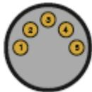
El módulo de referencia de alimentación phantom PAE5 M para instalaciones fijas y móviles cuenta con un conector XLR de cinco pines que permite llevar la señal de audio y la alimentación eléctrica para el anillo LED.
